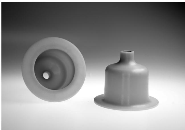
Die spezielle Form des Prüfkörpers erlaubt wesentlich realistischere Prüfverfahren für Bauteile aus Kunststoff. (© Fraunhofer LBF) | Bild in Farbe und Druckqualität: [www.fraunhofer.de/presse](http://www.fraunhofer.de/presse)
