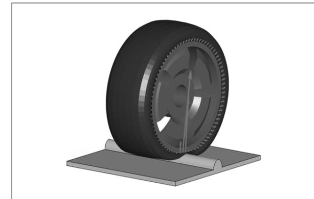
**CDTire/3D-Reifensimulation beim Überrollen eines Hindernisses. (© Fraunhofer ITWM) | Bild in Farbe und Druckqualität: [www.fraunhofer.de/presse](http://www.fraunhofer.de/presse)**
