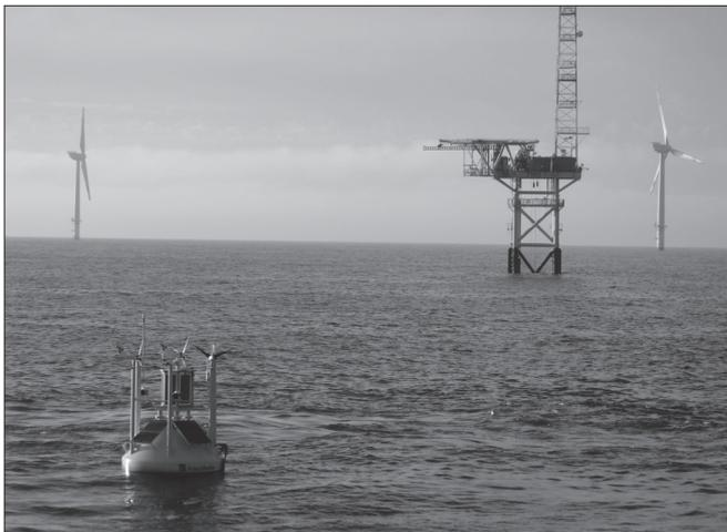
**Windmessboje mit ausgeklügelter, präziser Messtechnik in der Nordsee vor dem Messmast FINO 1.**
