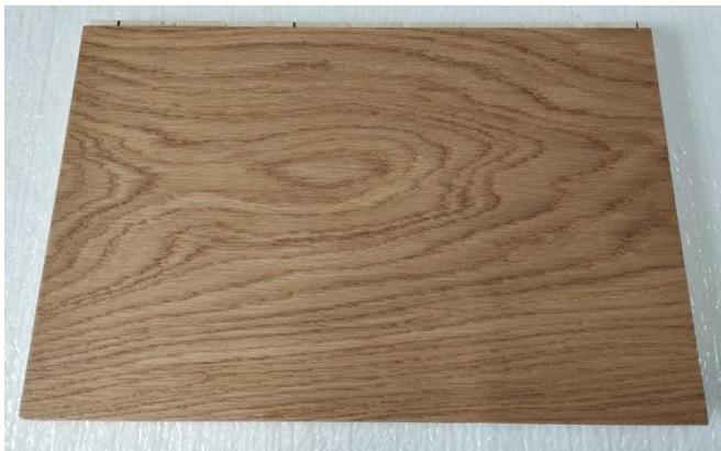
**Abb. 1** Oberflächenauftrag der Protein-Additiv-Kombination mit ölbasierter Endschicht auf Eichenparkett.
