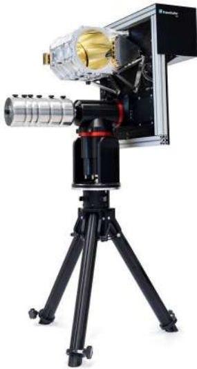
Teleskop für abhörsichere Quantenkommunikation Foto: Fraunhofer IOF
