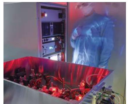
Laborprototyp für einen rauscharmen Quantenfrequenzkonverter Foto: Fraunhofer ILT
