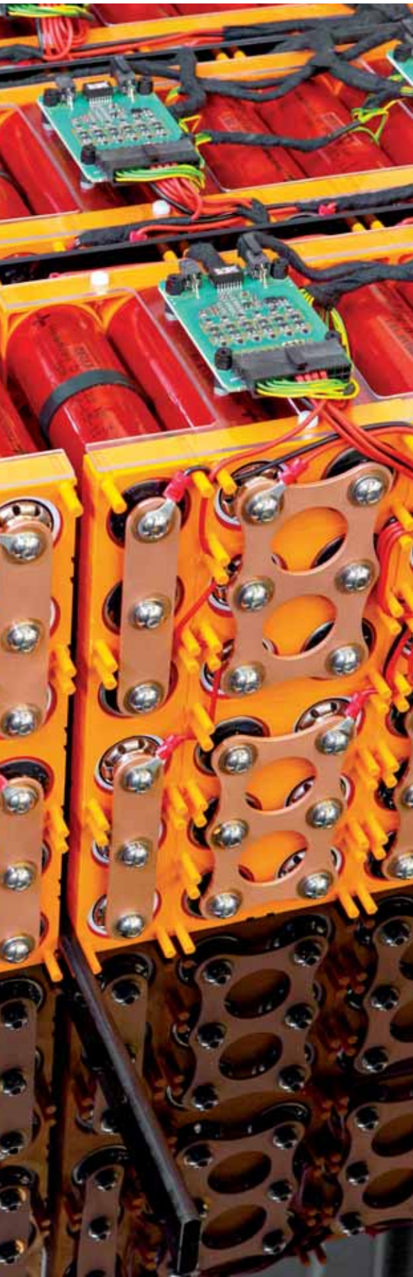
Leistungsstarkes 10 kWh-Batteriesystem mit eigensicheren LFP-Zellen und einem integriertem Batterie-Management- system. © Raapke/Fraunhofer LBF
