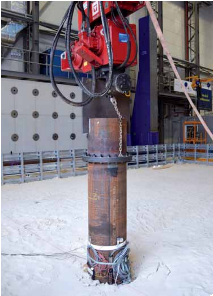
Meeresboden im Modellformat: Im Testzentrum werden Bauverfahren wie das schonende Einvibrieren von Stahlpfählen untersucht. © Fraunhofer IWES
