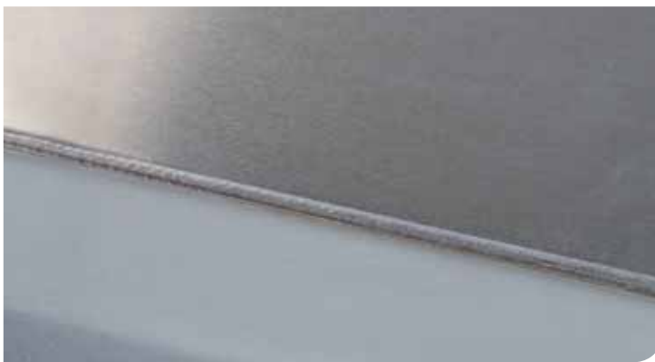
... das feste, qualitativ hochwertige Verbindungen zwischen Stahl und Aluminium herstellt. © Fraunhofer IPT
