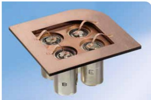
Kontaktierung von Batteriezellen Typ 18650 mittels Laserbonden. © Fraunhofer ILT
