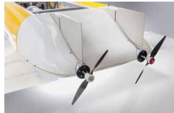
Ein Elektromotor treibt DEDAVE über zwei Propeller am Heck an. © indigo(c)2015
