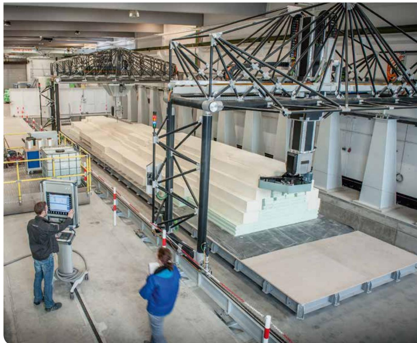
Im BladeMaker-Demonstrationszentrum können bis zu acht Prozessschritte an einem Fertigungsplatz maschinell erfolgen. Aus den aufgestapelten Blöcken entsteht eine Rotorblatt-Bauform. © Harry Zier/Fraunhofer IWES
