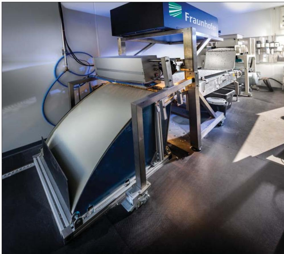
Die Sortiermaschine mit Fließband, das den kleingeschredderten Plastikmüll transportiert.
