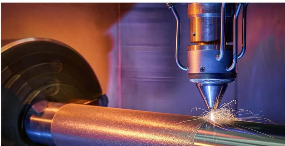
Mit EHLA lassen sich Metallschutzschichten mit extremer Hochgeschwindigkeit aufbringen. © Fraunhofer ILT, Aachen / Volker Lannert | Bild in Farbe und Druckqualität: [www.fraunhofer.de/presse](http://www.fraunhofer.de/presse)
