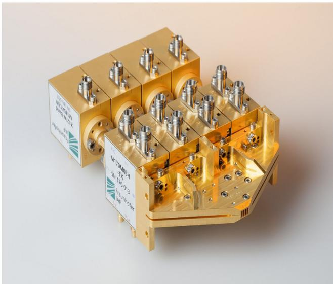
**Das Fraunhofer IAF fokussiert sich im Projekt TERRANOVA auf die Integration von Funkmodulen auf Chipebene. Im Bild zu sehen ist ein Funktionsprototyp eines 300 GHz Mehrkanal-Funksystems zur weiteren Integration als System-on-Chip. © Fraunhofer IAF | Bild in Farbe und Druckqualität: [www.fraunhofer.de/presse](http://www.fraunhofer.de/presse).**
