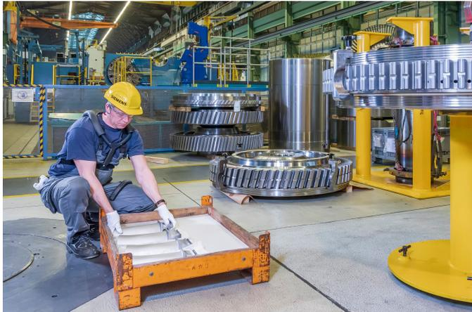
**Abb. 1** ErgoJack mit arretierbarem Hüftgelenk und Beinbügel unterstützt den Mitarbeiter beim Heben schwerer Lasten.
