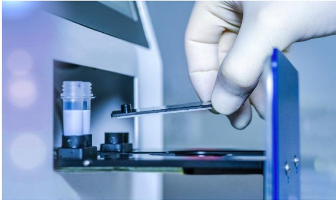
**Abb. 1 Das kompakte Gerät zum Nachweis multiresistenter Keime führt alle Reaktionsschritte automatisiert aus und liefert ein Ergebnis innerhalb einer Stunde. Schon ein einziges DNA-Molekül reicht für den Nachweis.**
