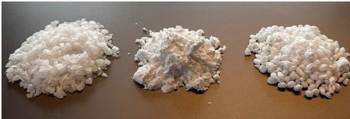
Abb. 2 Vom PCL (links) zum Komposit (rechts), gefüllt mit bioaktivem Glas (Mitte).
