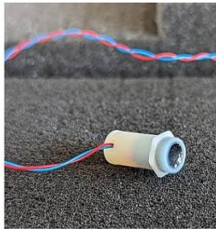
Abb. 1 Paralleler Fertigungsprozess für die Sensoren (links) sowie finaler Ultraschallwandler nach der Integration ins Gehäuse (rechts).
