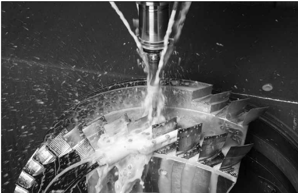
Das dreiteilige Spannsystem fixiert die Schaufeln der Blisk (untere Bildmitte in weißer Farbe). Von oben wird Kühlschmierstoff eingespritzt. (© Fraunhofer IPT) | Bild in Farbe und Druckqualität: www.fraunhofer.de/presse
