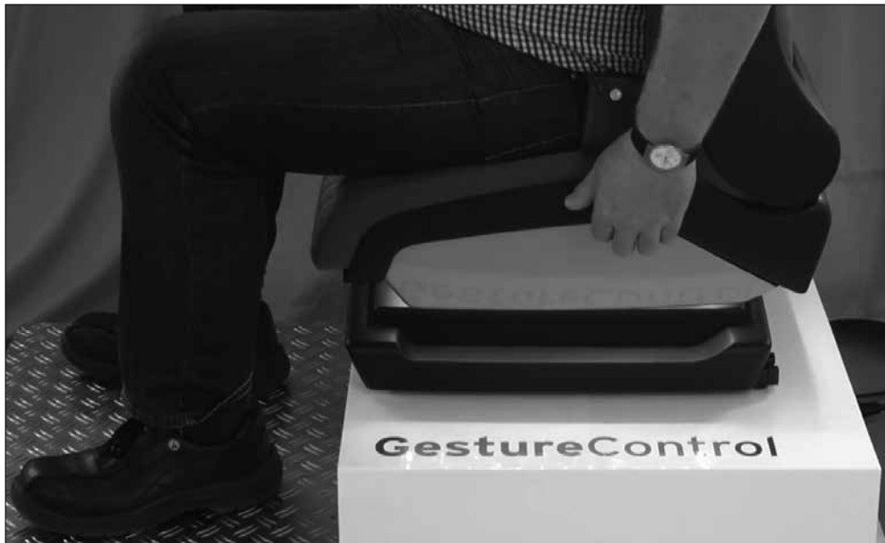
Einfach zur korrekten Sitzposition: Bei einem neuem Sitzmodell reichen dafür Handgesten an der Seitenabdeckung aus. (© Isringhausen GmbH) | Bild in Farbe und Druckqualität: www.fraunhofer.de/presse
