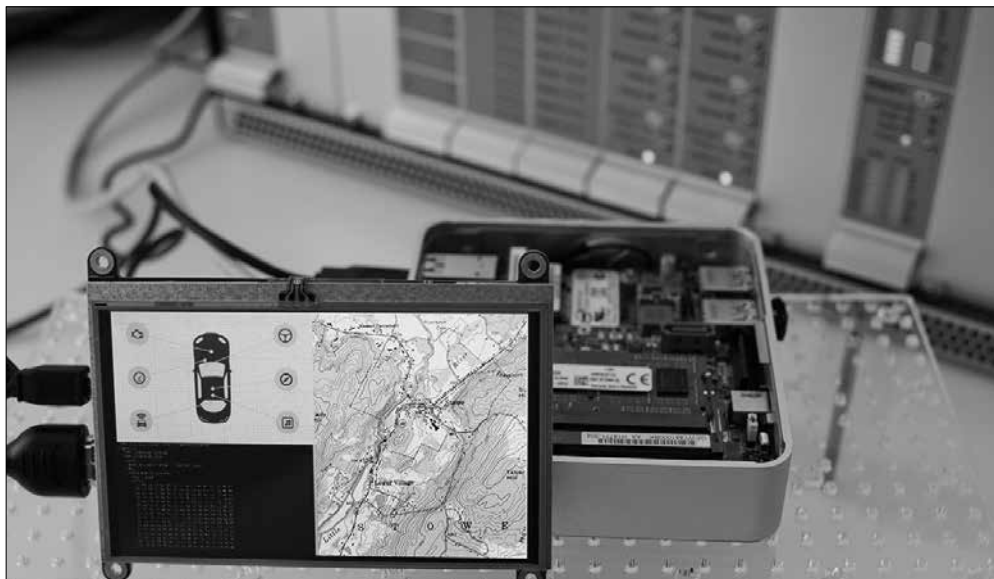
Der Demonstrator für eine »Head Unit« schützt sowohl Daten des Herstellers als auch private Daten des Fahrzeugnutzers vor unberechtigtem Auslesen. (© Fraunhofer SIT) | Bild in Farbe und Druckqualität: www.fraunhofer.de/presse
