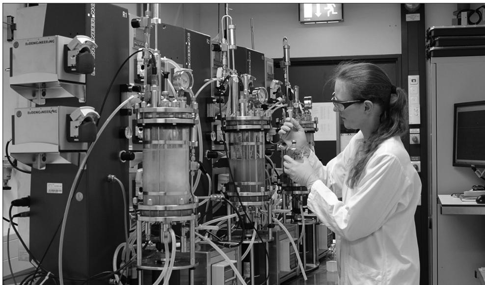
**Fraunhofer stellt in seinen Fermentationsanlagen mit Synthesegas aus Stahlwerken Alkohol und Aceton her. Daraus lassen sich Kraftstoffe und Spezialchemikalien gewinnen.**
