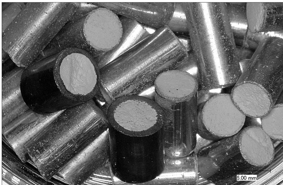
**Schüttgut ist Massenware in der chemischen Industrie. Das Fraunhofer IKTS schützt die millimetergroßen Partikel jetzt mit einem Metallmantel. Das erhöht ihre Wärmeleitfähigkeit um das Fünffache. (© Fraunhofer IKTS) | Bild in Farbe und Druckqualität: [www.fraunhofer.de/presse](http://www.fraunhofer.de/presse)**
