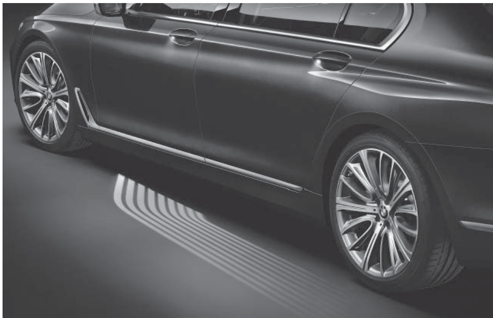
Mikrolinsen projizieren das Licht auf den Einstiegsbereich der neuen BMW 7er Reihe. (© BMW) | Bild in Farbe und Druckqualität: www.fraunhofer.de/presse
