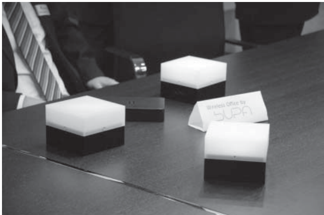
Diese Büroleuchten werden kabellos mit Energie versorgt. (© Fraunhofer ENAS) | Bild in Farbe und Druckqualität: www.fraunhofer.de/presse
