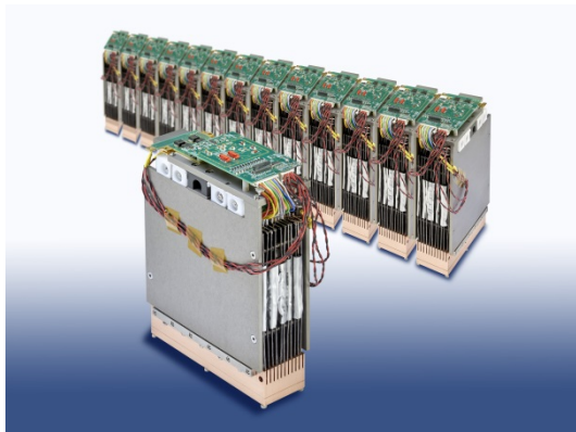
Lithium-Booster Batteriemodul mit 12 Hochleistungszellen und integrierter Elektronik (© Fraunhofer ISIT)
