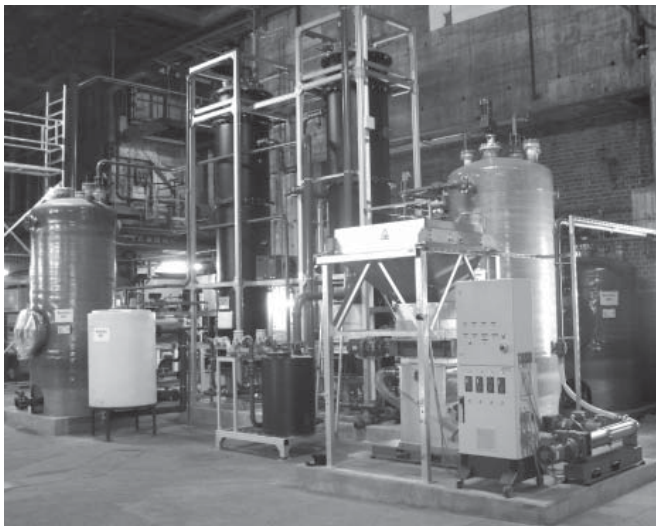
In dieser Stuttgarter Anlage wird aus Abfällen von Großmärkten Biogas hergestellt. (© Fraunhofer IGB)
