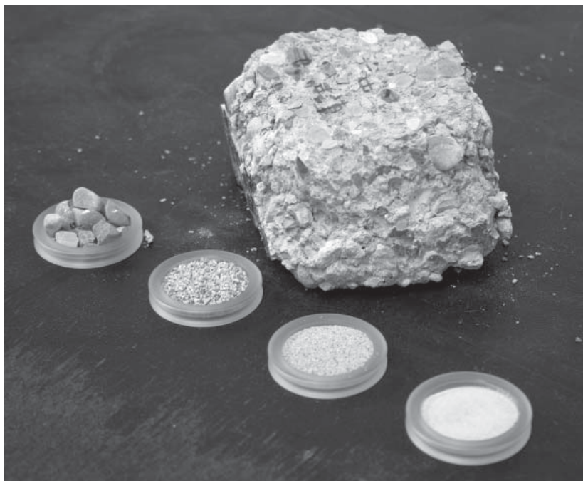
Forscher haben ein Verfahren entwickelt, das Beton in seine Bestandteile zerlegt. (© Fraunhofer IBP) | Bild in Farbe und Druckqualität: www.fraunhofer.de/presse
