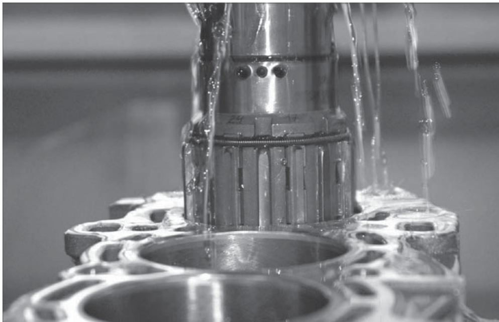
Das Honwerkzeug kann seine Form an den Zylinderkolben anpassen. (© Fraunhofer IWU) | Bild in Farbe und Druckqualität: www.fraunhofer.de/presse
