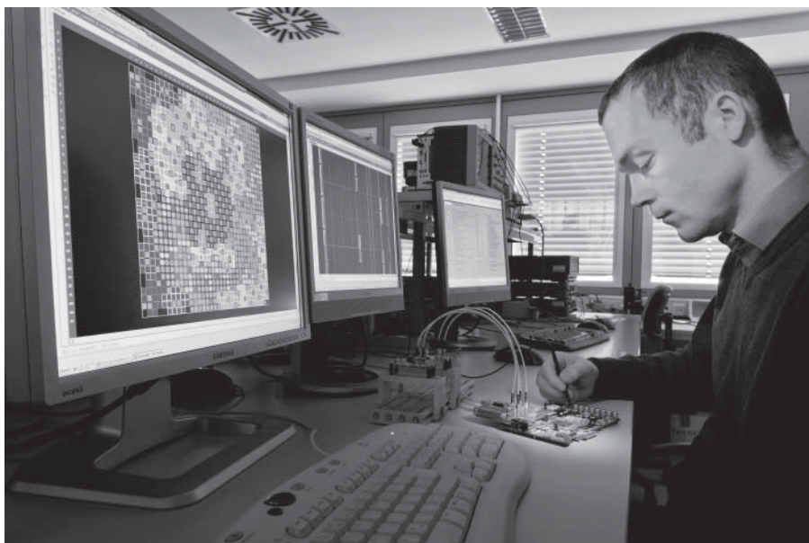
Dieses optische drahtlose Kommunikationsmodul bringt es auf eine Übertragungsrate von 3 Gbit/s. (© Fraunhofer IPMS/Jürgen Loesel) | Bild in Farbe und Druckqualität: www.fraunhofer.de/presse
