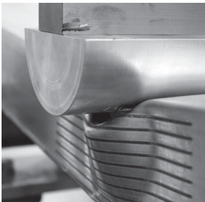
Bei diesem Crashtest wird geprüft, wie stark sich das Beispielbauteil unter einer Biegebelastung deformiert. (© Fraunhofer IWS) | Bild in Farbe und Druckqualität: www.fraunhofer.de/presse
