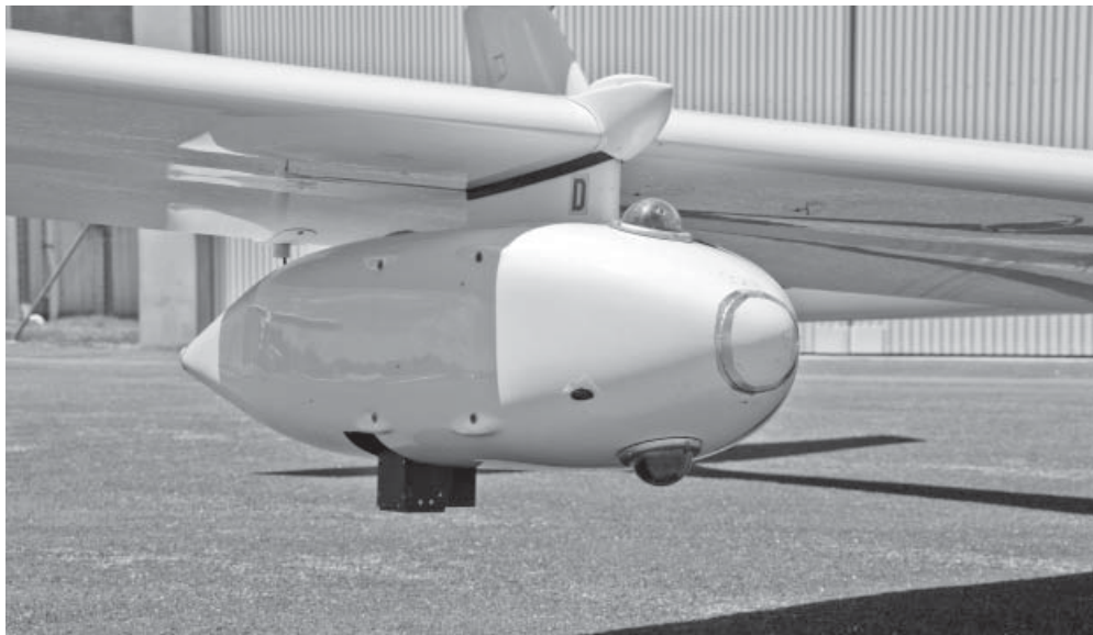
Die Hyperspektralkamera ist unter der Tragfläche des Forschungsflugzeugs angebracht. (© Fraunhofer IFF) | Bild in Farbe und Druckqualität: www.fraunhofer.de/presse
