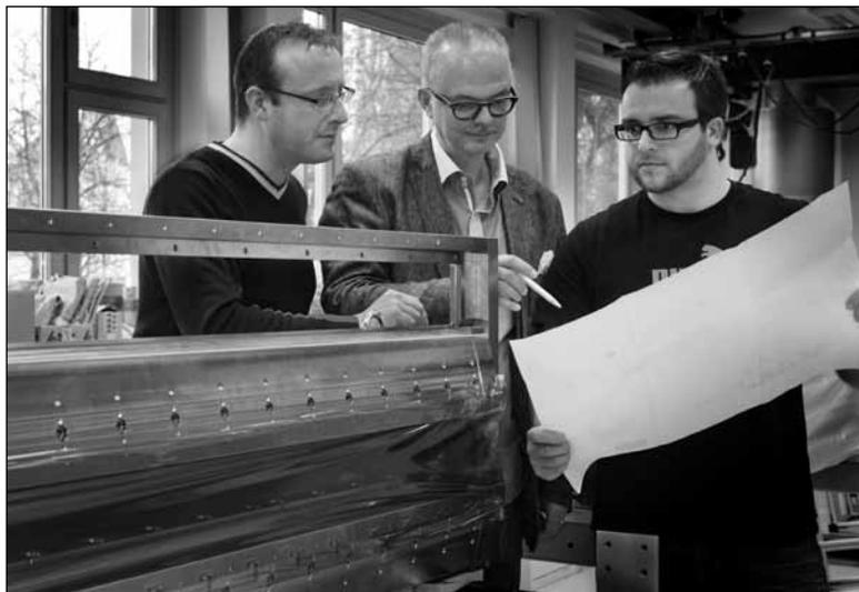
**Fertigungsprüfung einer speziellen Elektronenquelle für die neue Saatgutbehandlungsanlage im Fraunhofer FEP (© Fraunhofer FEP) | Bild in Farbe und Druckqualität: [www.fraunhofer.de/presse](http://www.fraunhofer.de/presse)**
