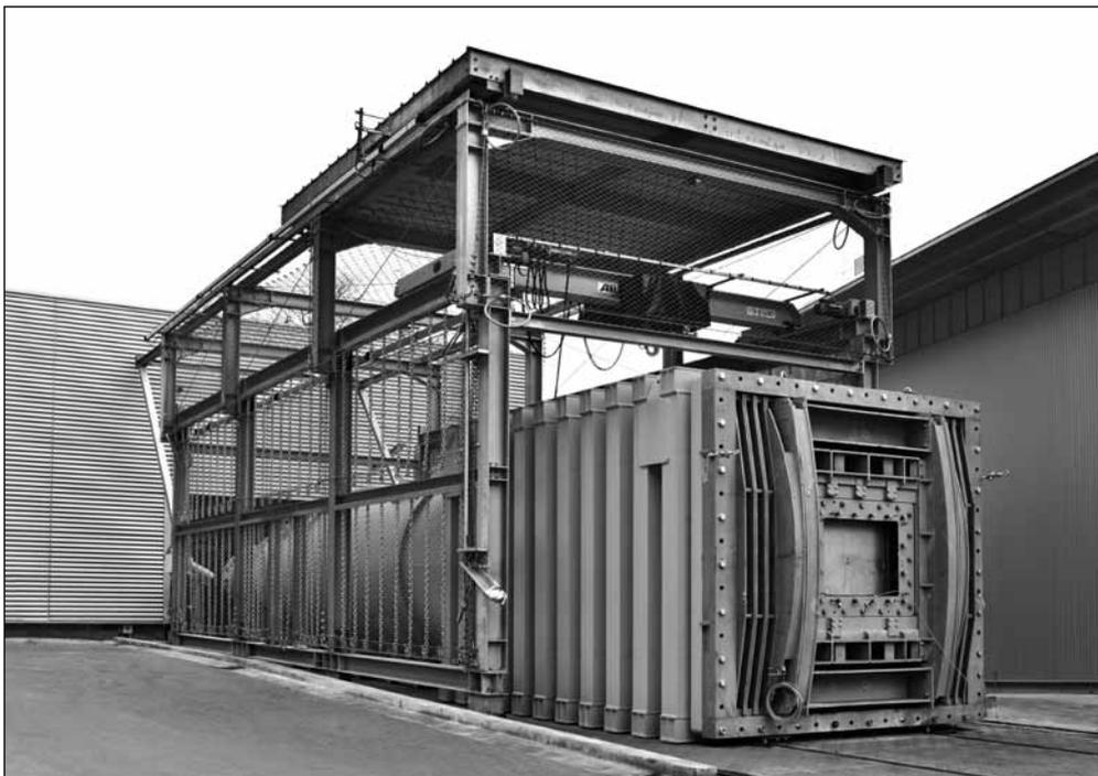
In dieser Anlage untersuchen Forscher, bei welcher Belastung Fenster und Glasfassaden zerstört werden. (© Fraunhofer EMI) | Bild in Farbe und Druckqualität: [www.fraunhofer.de/presse](http://www.fraunhofer.de/presse)
