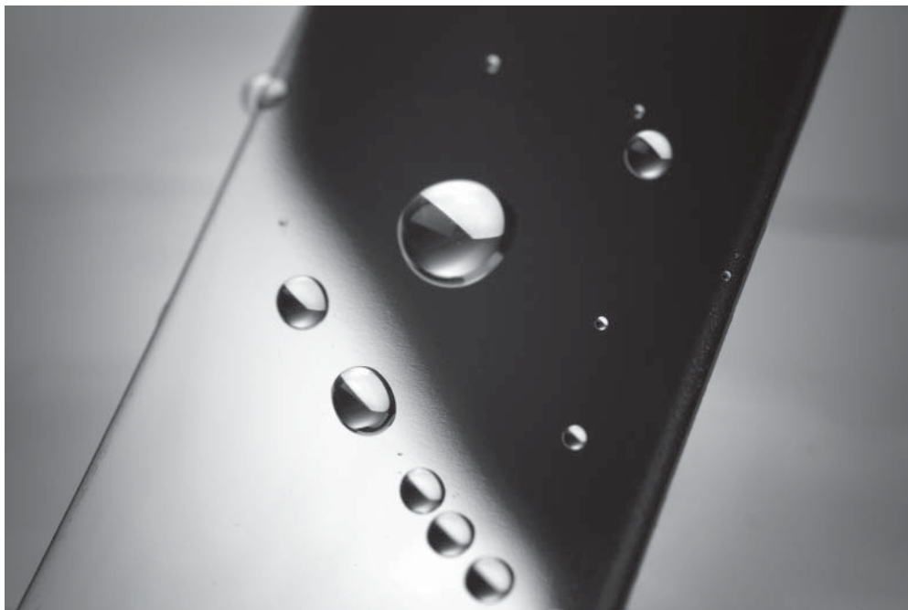
Wassertropfen auf einer Stahloberfläche mit Anti-Fouling-Beschichtung. (© Fraunhofer IST) | Bild in Farbe und Druckqualität: www.fraunhofer.de/presse
