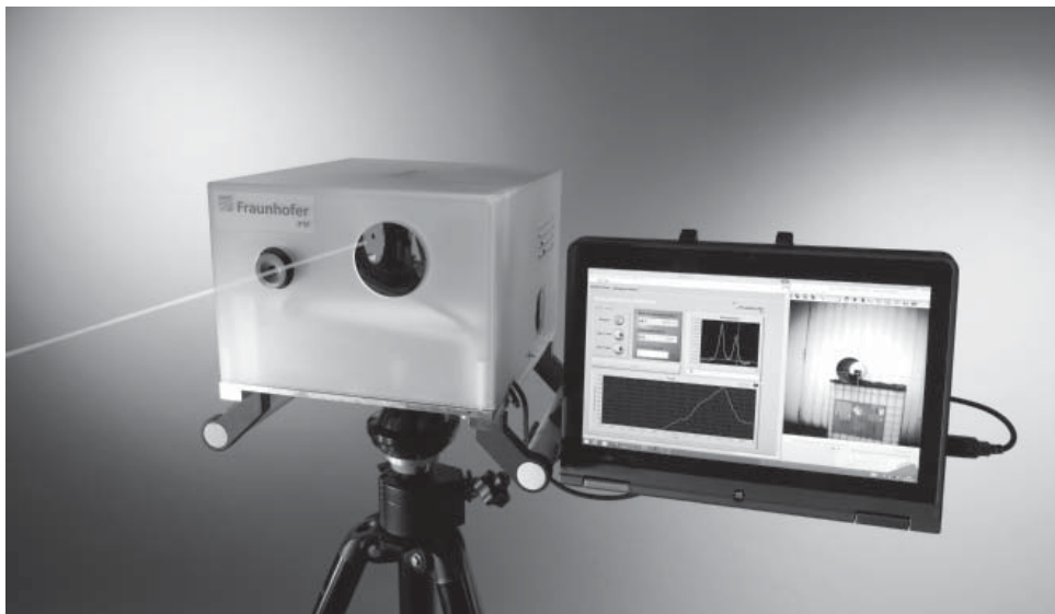
Das laserbasierte System misst austretendes Biogas berührungslos – selbst aus mehreren Metern Entfernung. (© Fraunhofer IPM) | Bild in Farbe und Druckqualität: www.fraunhofer.de/presse
