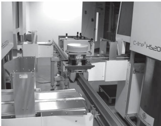
**Die Biobank besteht aus drei Kryotanks mit gekühlten Schutzhauben und einer Transferstation, von der aus die Probenbehälter über ein Schienensystem transportiert werden. Insgesamt haben ungefähr 60.000 Proben Platz. (© Fraunhofer IBMT) | Bild in Farbe und Druckqualität: [www.fraunhofer.de/presse](http://www.fraunhofer.de/presse)**
