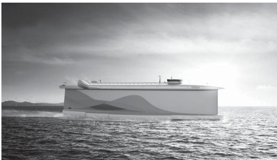
Der Rumpf des Cargo-Schiffs Vindskip™ wirkt wie ein großes Segel. (© LADE AS) | Bild in Farbe und Druckqualität: [www.fraunhofer.de/presse](http://www.fraunhofer.de/presse)
