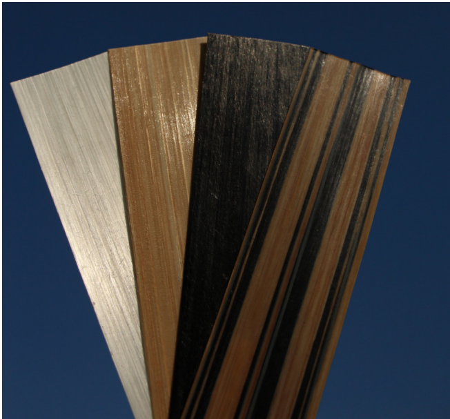
Thermoplast-Tapes mit unterschiedlicher Faser-Matrix-Kombination. © Fraunhofer ICT | Bild in Farbe und Druckqualität: www.fraunhofer.de/presse .
