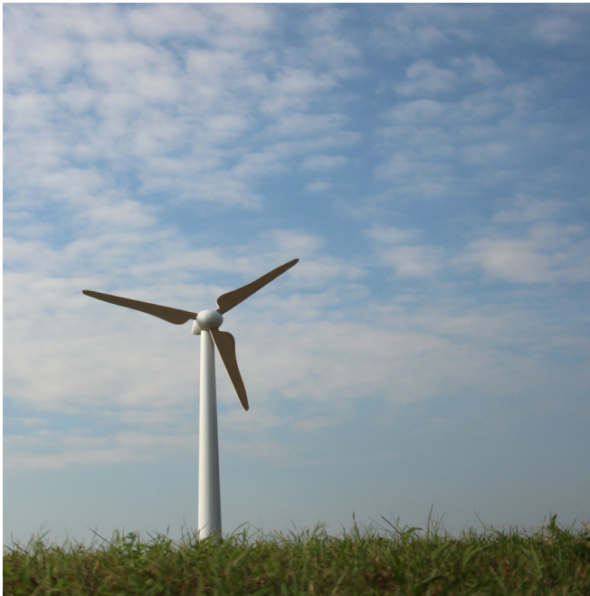
Modellwindrad mit Flügeln aus Sandwichelementen. © Fraunhofer ICT | Bild in Farbe und Druckqualität: www.fraunhofer.de/presse .
