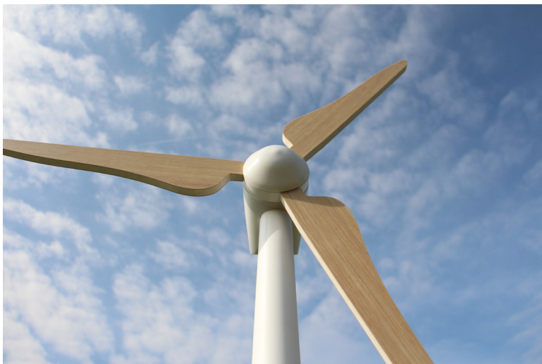
Rotorblätter aus thermoplastischen Sandwichmaterialien. © Fraunhofer ICT | Bild in Farbe und Druckqualität: www.fraunhofer.de/presse .
