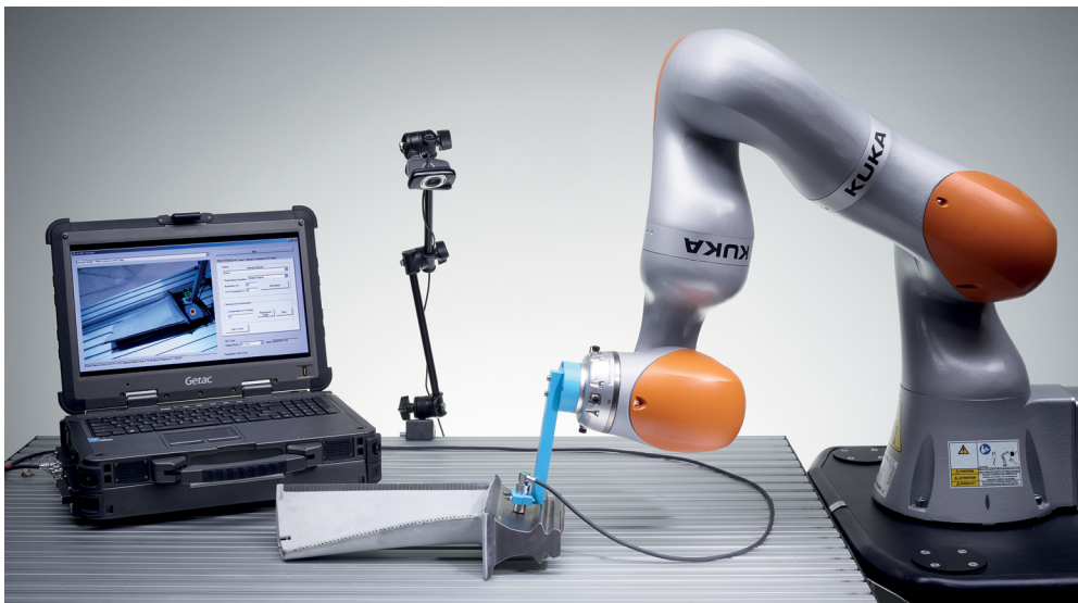
AR-System zur manuellen oder roboterunterstützten Prüfung von Bauteilen oder großen Oberflächen. © Fraunhofer IZFP | Bild in Farbe und Druckqualität: www.fraunhofer.de/presse .
