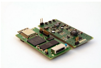
Messtechnikboard links, Stromversorgung rechts: Fraunhofer-Technologie bildet das Herz des mobilen Ultraschall-Messsystems »PRIMSA«. © Fraunhofer IBMT | Bild in Farbe und Druckqualität: www.fraunhofer.de/presse .
