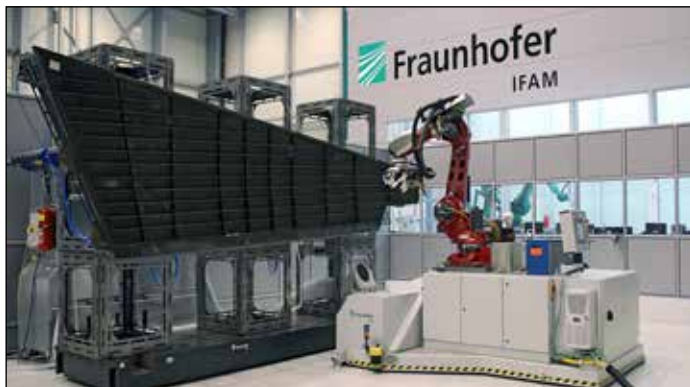
Der mobile Roboter bearbeitet das Seitenleitwerk eines Airbus 320. © Fraunhofer IFAM | Bild in Farbe und Druckqualität: www.fraunhofer.de/presse .
