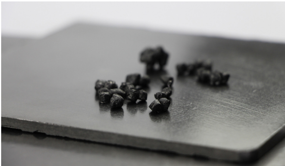
Das Fraunhofer ICT stellt aus recycelten, klein gehäckselten Carbonfasern (oben) Bipolarplatten (unten) für Batterien und Brennstoffzellen her. © Fraunhofer ICT | Bild in Farbe und Druckqualität: www.fraunhofer.de/presse .
