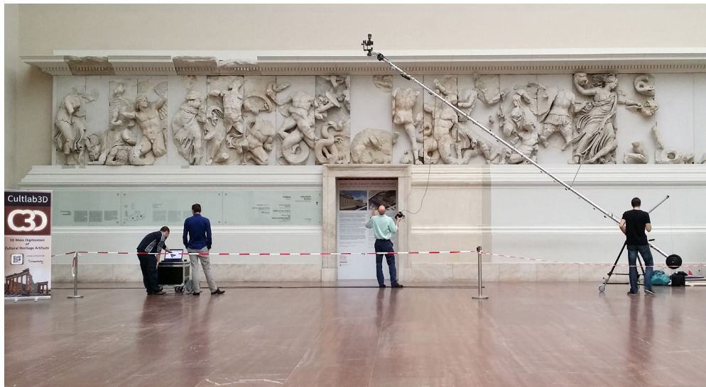
Forscher erfassen den Fries des Pergamonaltars mit einem Laserscanner. © Fraunhofer IGD | Bild in Farbe und Druckqualität: www.fraunhofer.de/presse .
