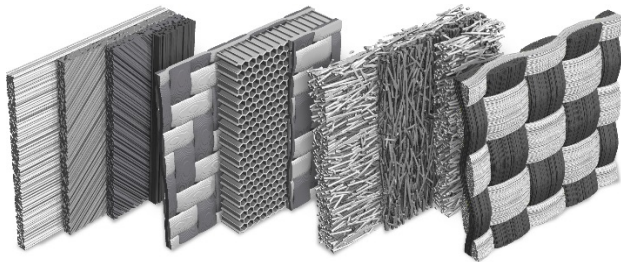
Gelege-, Sandwich-, Kurzfaser- und Gewebestruktur modelliert mit der Software GeoDict © Math2Market
