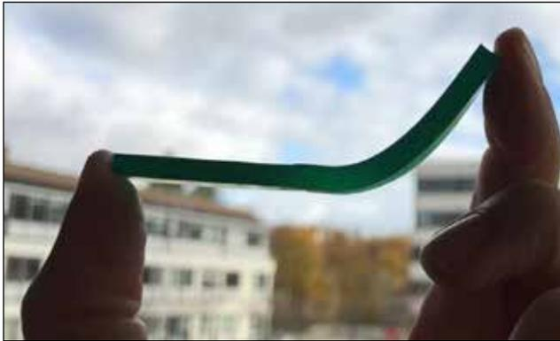
**Biessam und hart in einem Stück: das neue Kunststoff-Metamaterial MetAK. © Fraunhofer LBF | Bild in Farbe und Druckqualität: [www.fraunhofer.de/presse](http://www.fraunhofer.de/presse).**
