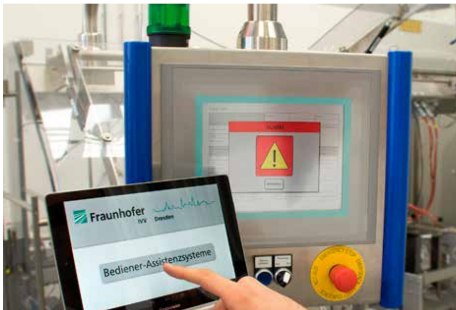
Das selbstlernende Assistenzsystem SAM unterstützt Maschinenbediener bei der Fehlerbehebung in Produktionsanlagen.
