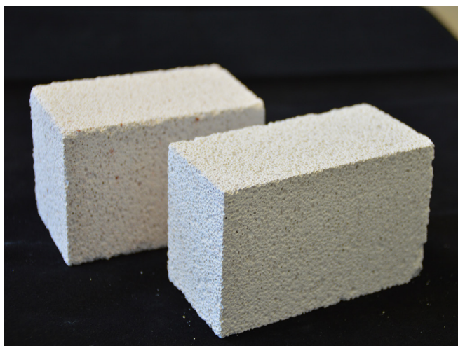
Porenbeton aus Ziegel (hinten), Porenbeton aus Kalksandstein (vorne) © Fraunhofer IBP | Bild in Farbe und Druckqualität: www.fraunhofer.de/presse .
