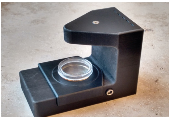
Abb. 1 Das holografische Mikroskop ermöglicht ein automatisches, dreidimensionales Tracking der Immunzellen in Echtzeit.
