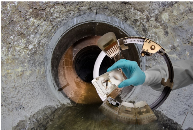
Abb. 1 Sensorring für den Einsatz in Abwasseranlagen.
