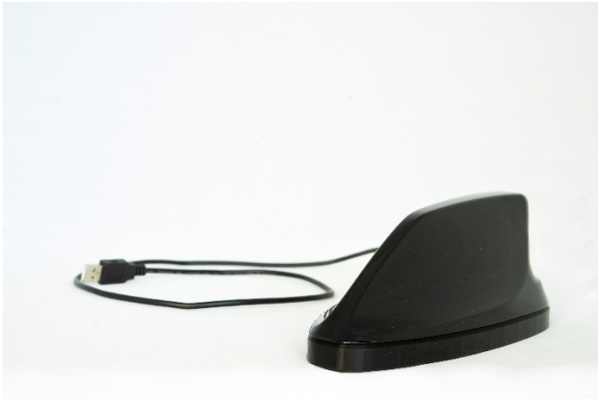
Abb. 1 Das Auto lernt hören: Modifizierte Dachfinne zur Erprobung von Sensoren für die akustische Erfassung von Außengeräuschen an einem Fahrzeug.
