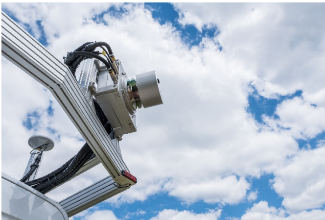
Abb. 1 Eingehauster 3D-Laserscanner – fertig montiert auf dem Dach eines Messfahrzeugs.
