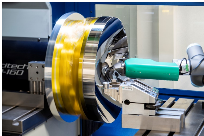
Abb. 2 Fertigungsbegleitende Rauheitscharakterisierung in einer Diamantdrehmaschine mit einem Streulichtsensor
