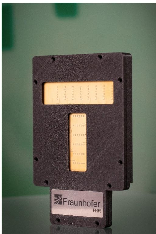
**Abb. 1** Am Fraunhofer FHR entwickelter MIMO-Radarsensor zur Bewegungserfassung.
