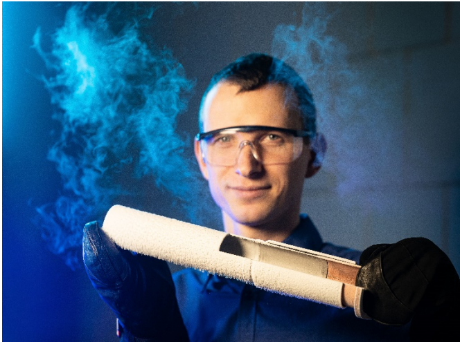
Abb. 1 Das Magnetpulsschweißen ermöglicht stoffschlüssige Verbindungen zwischen verschiedenartigen Materialien wie Kupfer, Aluminium und Stahl und erfüllt die Dichtungsanforderungen auch bei sehr tiefen Temperaturen, beispielsweise in Systemen zum Speichern und Verteilen von flüssigem Wasserstoff.
