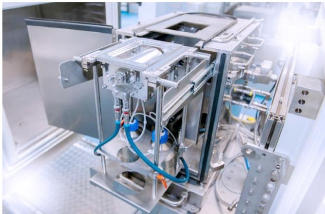
**Abb. 2** Das Flüssigkeitsrollensystem in der Prototyp- und Forschungsanordnung: Die Entwicklung des automatisierten Prozessmoduls macht diese Technologie leicht skalierbar und einsatzbereit für die pharmazeutische Industrie.
