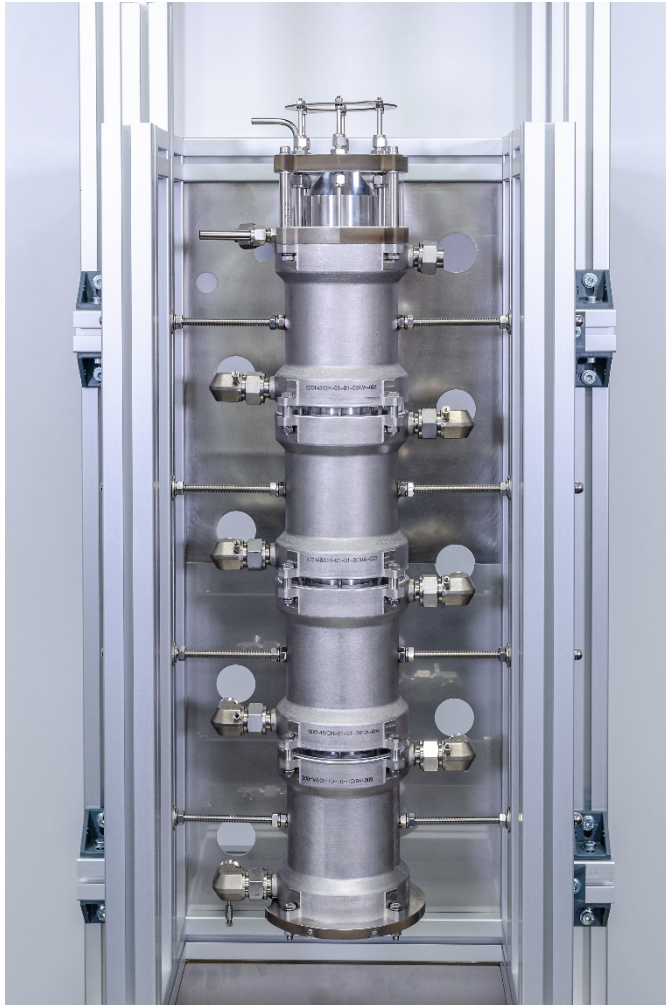
Abb. 3 Modularer Pilotierungsaufbau zur Grignard-Reagenssynthese mit bis zu 20 L/h Durchsatz.
