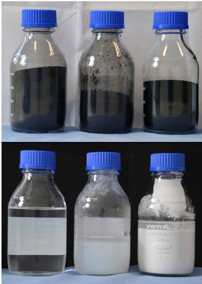
Abb. 1 Oben, Primärprodukt von links nach rechts: Roh-rCB, Clean rCB (96+), perliertes Clean rCB (96+). Unten, gewonnene Sekundärprodukte aus der Asche von links nach rechts: »Wasserglas«, gefälltes \text{SiO}_2 , gefälltes \text{ZnSO}_4 .
