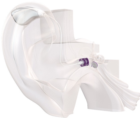
Abb. 1 Die Hörkontaktlinse® und das Gehörgangsmodul werden mit dem Klangprozessor, der hinter dem Ohr getragen wird, verbunden. Dieser kann flexibel abgenommen werden und umfasst neben der Signalverarbeitungselektronik auch die Batterie. Gehörgangsmodul und Hörkontaktlinse® verbleiben fest im Ohr.
