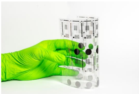
Abb. 1.: Gedruckte Funktionalitäten auf einer flexiblen Polymerfolie zur Abdeckung von Mikrofluidik-Chips. © Fraunhofer IOF
