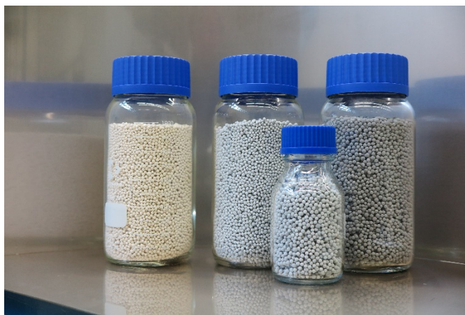
Abb. 2 Zeolith-Granulat im Originalzustand (links) sowie mit Aluminium beschichtet.
